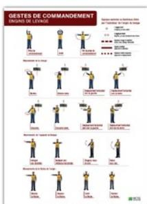
Gestes de commandement - Engins de levage
